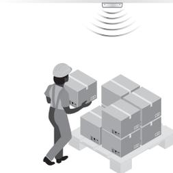
Verwenden Sie Impinj-Lesegeräte und -Gateways an Palettenaufbau Stationen, um jede Kiste bzw. jeden Karton bei Platzierung auf der Palette drahtlos zu identifizieren.
